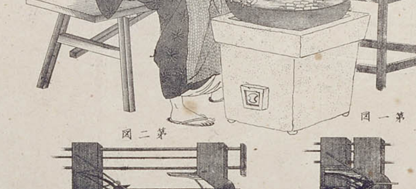
此器は、先年、農商省、有給、蠶業、試験、場、中、發明、の、器、に、て、其、効、用、は、蒸、氣、の、温、熱、を、以、て、殺、蛹、を、致、さ、ず、かつ、水、分、を、食、ひ、又、乾燥、の、如、く、其、質、を、養、ひ、其、質、を、解、し、且、先、次、量、に、減、ら、ぬ、該、器、は、方、尺、五、寸、の、大、に、し、て、普通、の、金、三、拾、錢、に、備、へ、て、造、り、し、者、女、子、一、日、四、五、十、貫、目、の、生、繭、を、殺、蛹、す、可、し、
